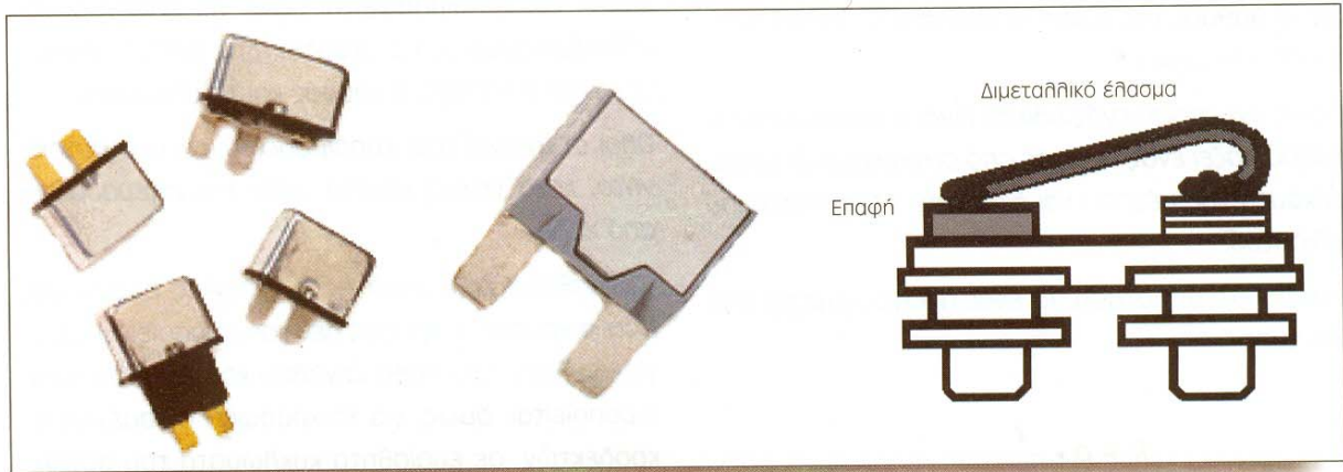
Σχίμα 3.8. Θερμικοί ασφαλειοδιακόπτες αυτοκινήτων.
