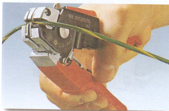
Σχήμα 1: Τοποθέτηση καλωδίου στον απογυμνωτή
