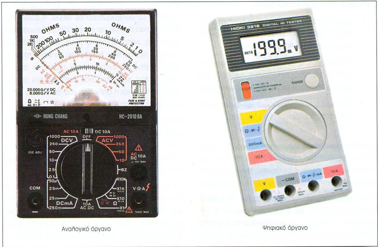
Σχήμα 4.6. Εξωτερική μορφή αναλογικού οργάνου και ψηφιακού οργάνου.
