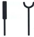
Αρσενική και θηλυκή επαφή με στρογγυλούς ακροδέκτες
