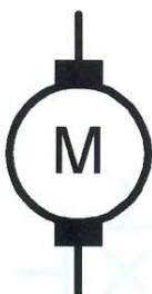
Κινητήρας συνεχούς ρεύματος, σταθερού μαγνήτη.
