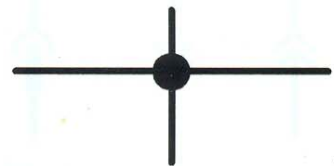
Διασταύρωση αγωγών με κολλητή ένωση
