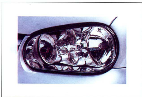
Σχήμα 5.15. Φωτιστικό συγκρότημα μπροστινών φώτων σε μία ολοκληρωμένη μονάδα.
